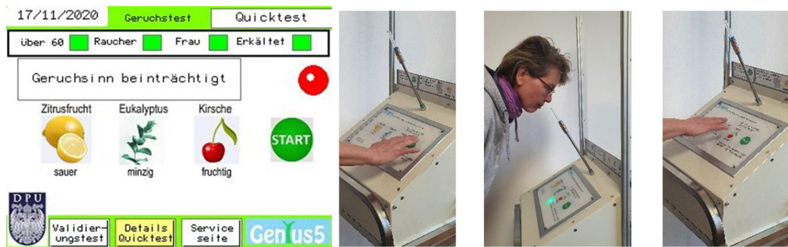
Abbildung 17: Bedienungseinheit des über Touchscreens (links) und Bedienungspanel steuerbaren Anwenderteils (rechts) inklusive berührungslos steuerbarer Einheit für die ProbandInnen
